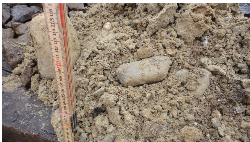
Fig. 12: Structure / propriété / qualité des matériaux à l'aide d'une photo des déblais de voies
