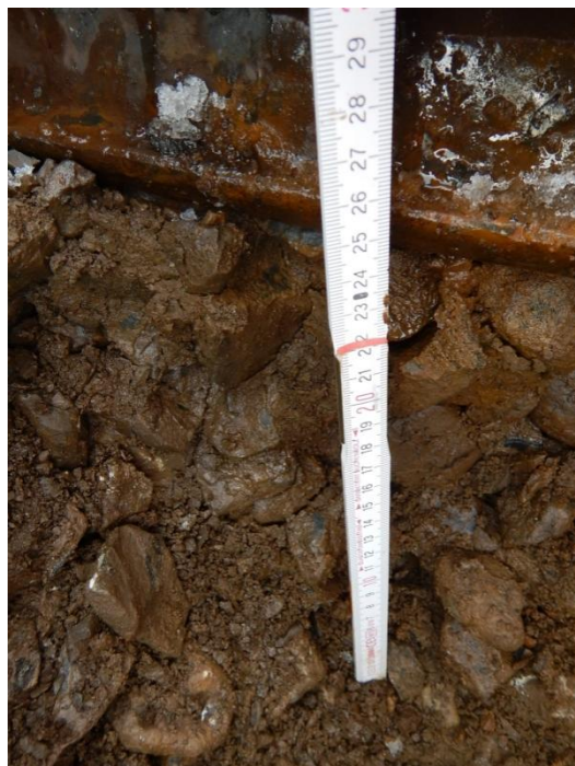
Fig. 6: Catégorie de criblage S2-3 (moyennement à beaucoup de déchets d'exploitation et moyennement à beaucoup de concassés de ballast) ; vides à peine visible, majoritairement remplis par des particules fines non cohésives – cependant par temps mouillé la réussite du criblage est réduite: Test sur le terrain avec la fourche à ballast produit des grains isolés.
