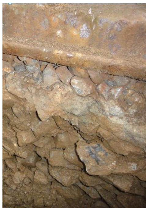
Fig. 2: Catégorie de criblage S2 (moyennement de déchets d'exploitation) ; vides visibles, parfois remplis par des particules fines non cohésives: Test sur le terrain avec la fourche à ballast produit des grains isolés. De plus: granularité suffisante, grains parfois recouverts de particules fines, arêtes vives à arrondies
