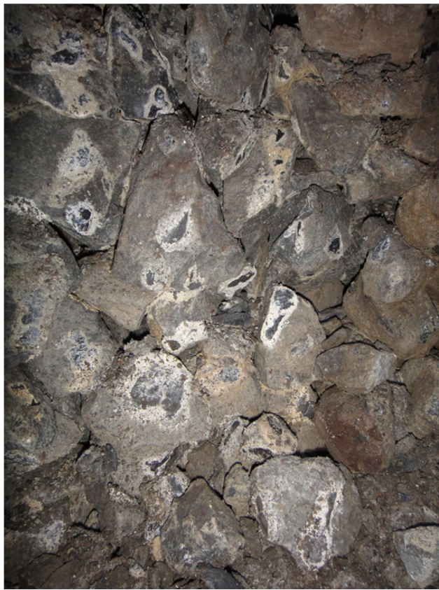
Fig. 1 (haut) et 2 (droite): Empreintes dues à l'appui grain sur grain; en cas d'une faible charge dynamique, ces empreintes sont une indication d'une résistance insuffisante – en cas de haute charge ces impressions peuvent être dues à une sollicitation excessive
