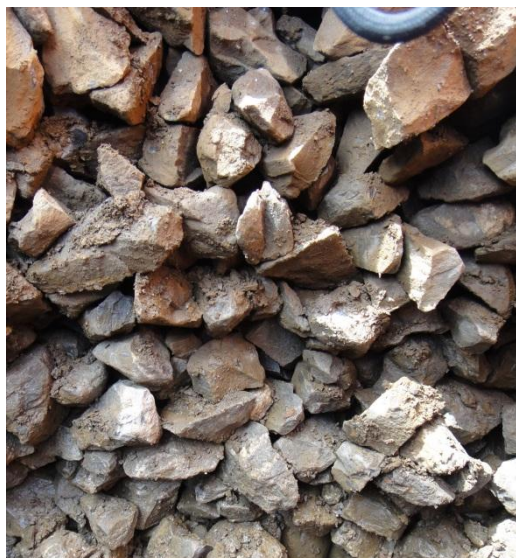
Fig. 3: Catégorie de criblage S1-2 (peu à moyennement de déchets d'exploitation et concassés de ballast) ; De plus: bonne granularité, arêtes vives ; vers le bas plus de concassé et de déchets visibles (lavés et tombés vers le bas)
