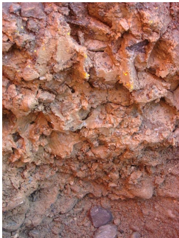
Fig. 5: Catégorie de criblage S3 (beaucoup de déchets d'exploitation et de concassé de ballast resp. d'abrasion des grains) ; vides remplis par des particules fines cohésives – pollution par le haut resp. du lit de ballast lui-même criblage plus vraiment efficace
