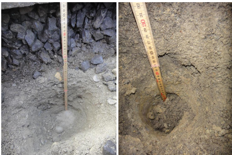
Fig. 7 - 9: Profil à travers le lit de ballast; double-mètre sur la couche de base; aspect forme de grains, aptitude au criblage (exemples donnés); aspect de l'épaisseur du lit de ballast; contamination basale (gauche: la zone inférieure est vraisemblablement composée des résidus du dernier renouvellement des voies (horizon de criblage))
