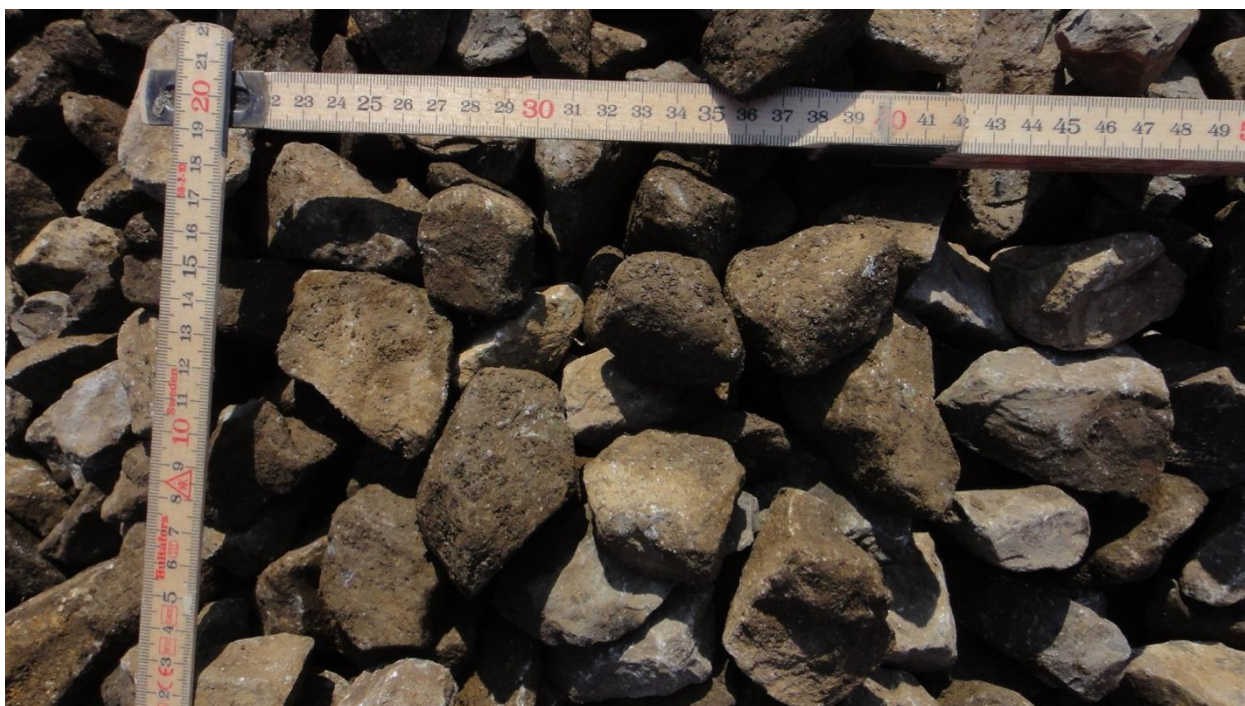
Fig. 6: grains majoritairement arrondis (vieux ballast lavé)
