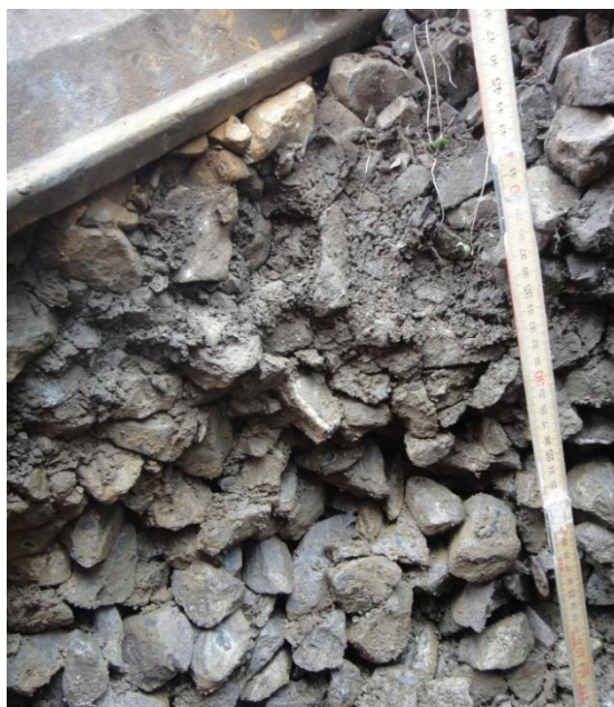
Fig. 3: catégorie de ballast S1-2 (peu à moyennement de déchets d'exploitation et de concassé de ballast, dans la zone de bourrage S2-3) par-dessus S1. Dans la zone de bourrage, encore tous les grains de ballast disponibles et donc bourrage encore efficace .
