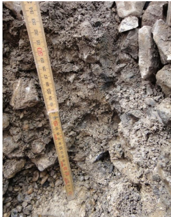
Fig. 2: catégorie de criblage S3 (beaucoup de déchets d'exploitation et de concassé de ballast dans la zone de bourrage) pores remplis par des particules fines non cohésives resp. du sable; plus assez de grains de ballast dans la zone de bourrage donc bourrage plus vraiment efficace
