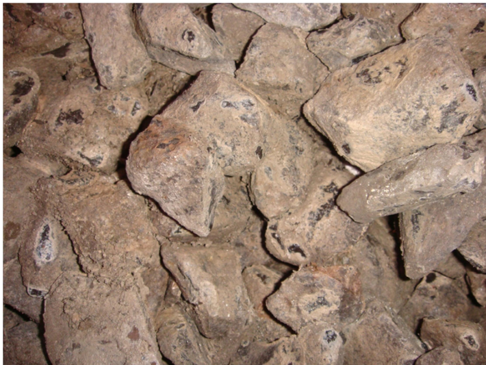
Fig. 1 (haut) et 2 (droite): Empreintes dues à l'appui grain sur grain; en cas d'une faible charge dynamique, ces empreintes sont une indication d'une résistance insuffisante – en cas de haute charge ces impressions peuvent être dues à une sollicitation excessive
