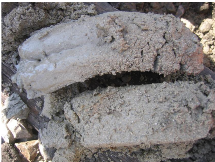
Fig. 13: Structure / propriété / qualité des matériaux à l'aide d'une photo des déblais de voies (tarière à mains; ici la consistance décroissante des particules fines)
