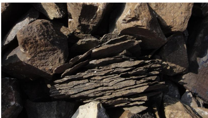
Fig. 3 et 4: grain pas résistant au gel (doit composer <5% du pourcentage de la masse)
