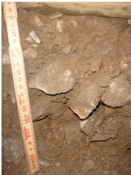
Fig. 5: Catégorie de criblage S3 (beaucoup de déchets d'exploitation et de concassé de ballast resp. d'abrasion des grains) ; vides remplis par des particules fines cohésives – pollution par le haut resp. du lit de ballast lui-même criblage plus vraiment efficace
