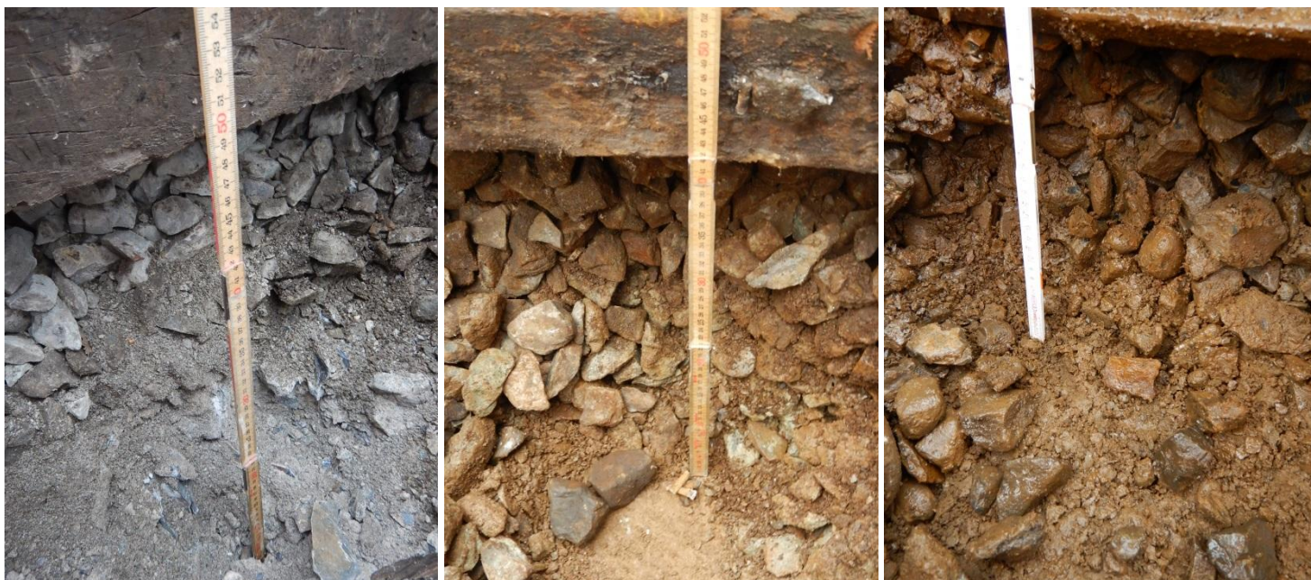
Fig. 7 - 9: Profil à travers le lit de ballast; double-mètre sur la couche de base; aspect forme de grains, aptitude au criblage (exemples donnés); aspect de l'épaisseur du lit de ballast; contamination basale (gauche: la zone inférieure est vraisemblablement composée des résidus du dernier renouvellement des voies (horizon de criblage))
