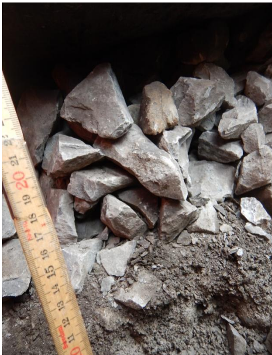
Fig. 1: lit de ballast jeune et pas encore bloqué; les grains ne présentent que des points de contact ponctuels; lors de l'ouverture de la fouille de sondage, beaucoup de ballast tombe au-dessous des traverses, autant des traverses en bois ou béton; élasticité existante dans le lit de ballast.
