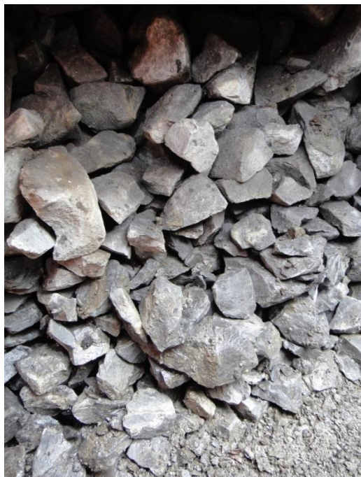
Fig. 1: Catégorie de criblage S1 (peu de déchets d'exploitation et de concassé de ballast) ; De plus: bonne granularité, arêtes vives; vers le bas les grains sont orientés latéralement
