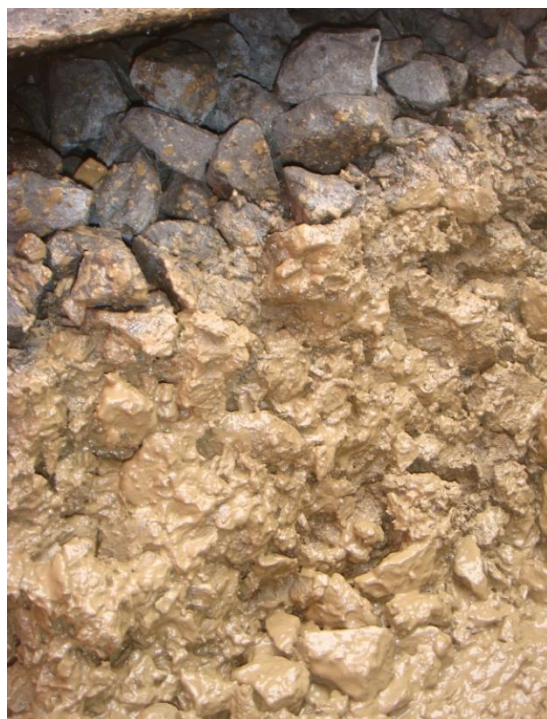
Fig. 7 et 8: Catégorie de criblage S4 (remontée de particules fines du dessous) ; vides à peine visibles, majoritairement remplis par des particules fines cohésives – criblage plus possible ; Test sur le terrain avec la fourche à ballast produit des mottes resp. des agrégats.
