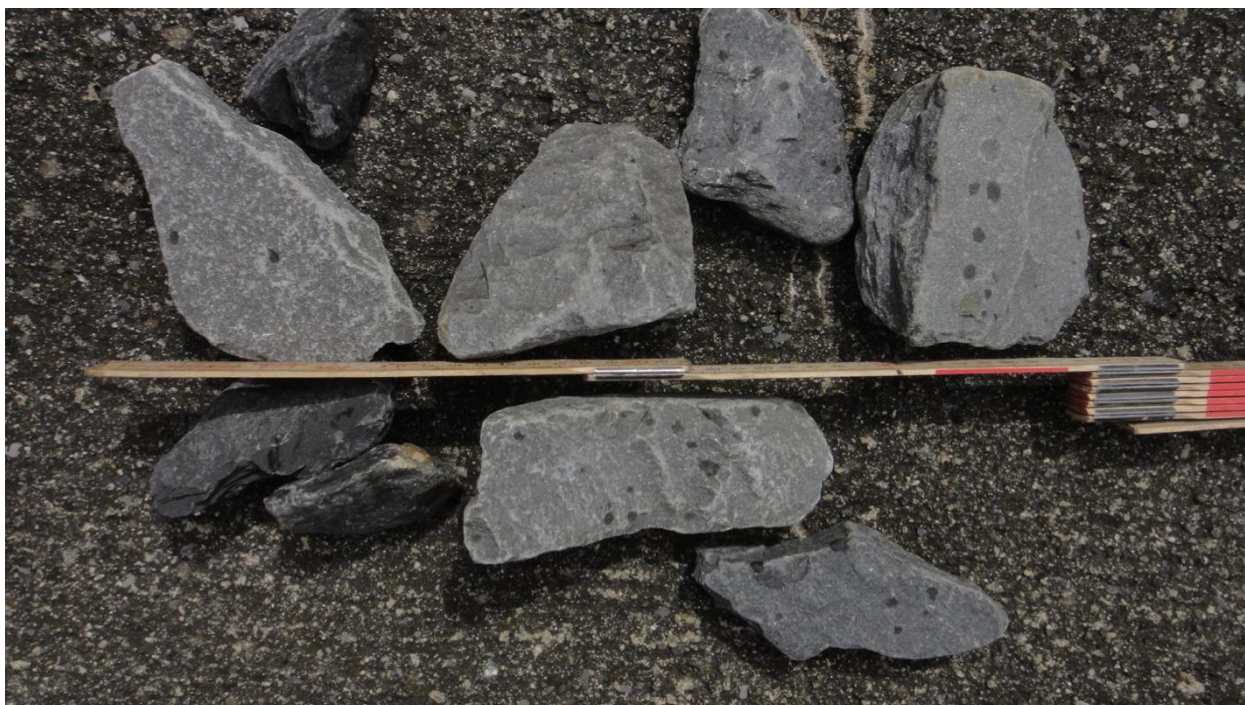
Fig. 5: grains majoritairement à arêtes arrondies (nouveau ballast)
